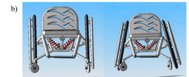
Rys.6. Wózek sportowy: a) regulacja podnóżka, b) regulacja kąta nachylenia kół jezdnych
